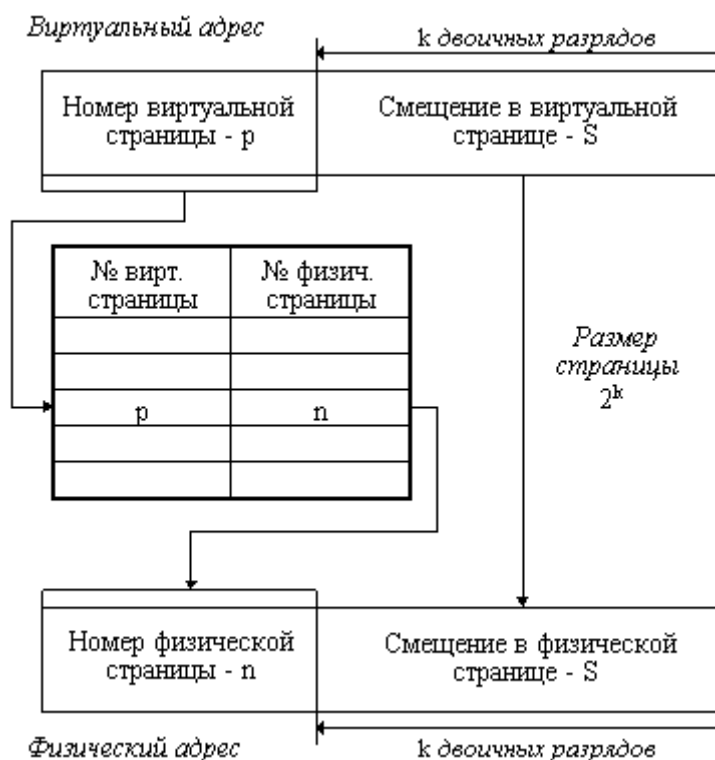
Рис. 2.13. Механизм преобразования виртуального адреса в физический при страничной организации памяти
